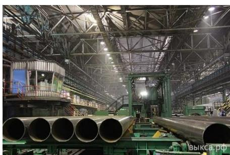
Технический проект оборудования турбоэлектросварочного агрегата «203-530» был разработан Электростальским заводом тяжёлого машиностроения. Подготовка площадки под строительство цеха началась в феврале 1973 года. ТЭСЦ-3 был пущен в работу в декабре 1977 года. В его составе – турбоэлектросварочный стан «203-530», участок объёмной термообработки труб с двумя печами нормализации, участок отделки.
